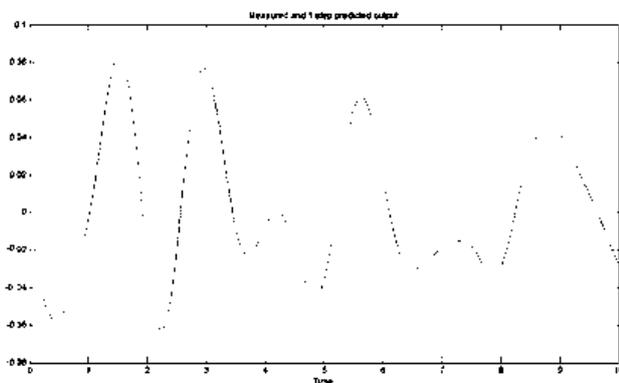
Gambar 22. Grafik perbandingan data terbang vs prediksi mode longitudinal
